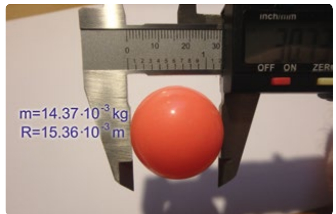
9. ÁBRA \omega = 156 \text{ s}^{-1} , E_{kin,tr(1)} = 2,46 \cdot 10^{-2} \text{ J} , E_{kin,tr(2)} = 4,14 \cdot 10^{-2} \text{ J}
