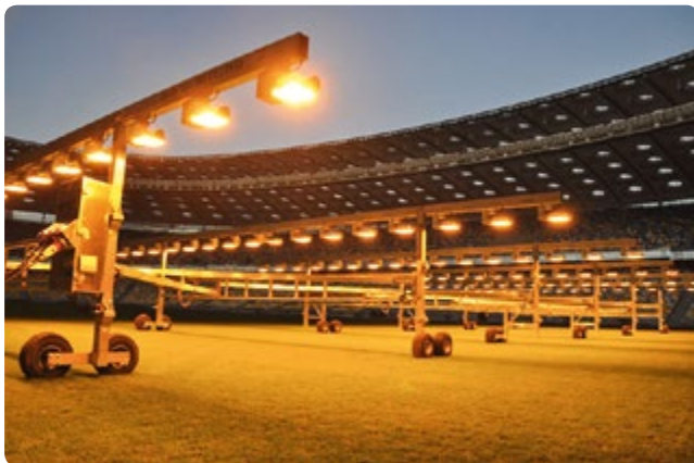
FIG. 1 Dispositifs d'éclairage permettant d'accélérer la croissance des graminées
