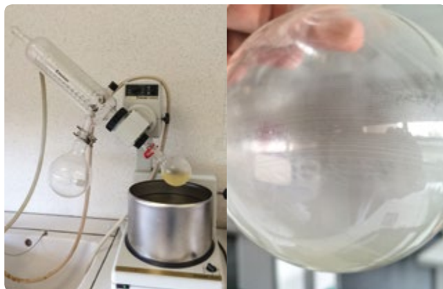
FIG. 8 Évaporation du solvant au moyen d'un évaporateur rotatif (gauche) · Dépôt de poudre sur les parois du flacon après évaporation du solvant
