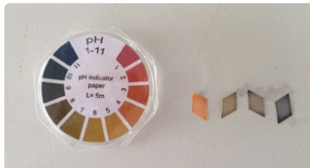
FIG. 2 Vérification de la basification avec du papier pH
